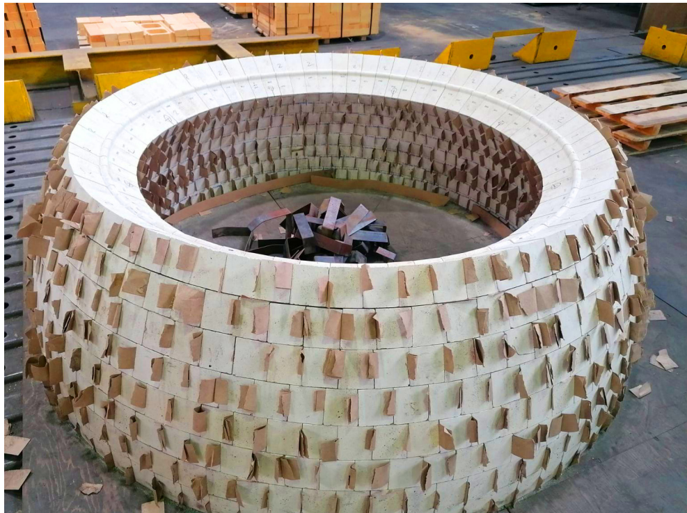
Стендовая сборка купола для АО «СЧПЗ».
